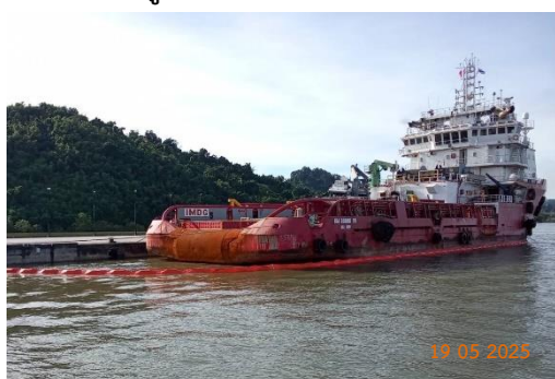
รูปที่ 2-17 ทูนกักน้ำมัน
