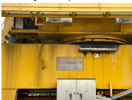
รูปที่ 2-17 ทูนกักน้ำมัน
